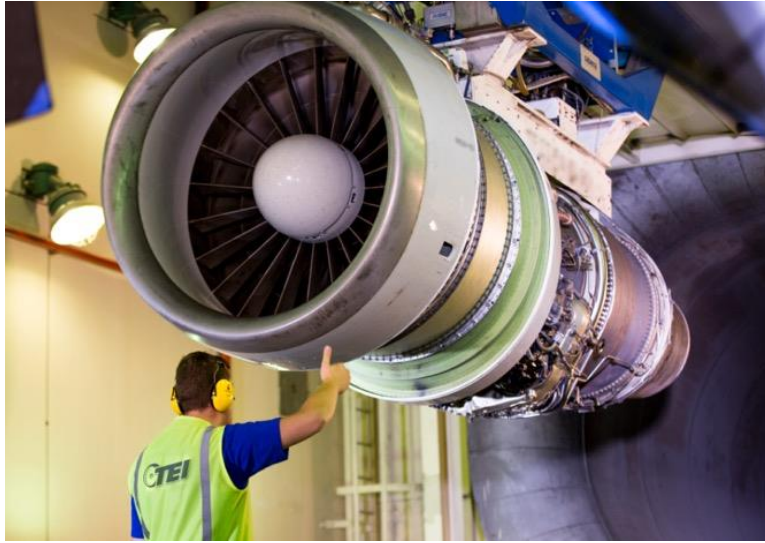
Şekil 19. TEİ Eskişehir tesislerinde bulunan 100.000 lbf itki kapasiteli Turbofan/Turbojet motor test bremzesi
