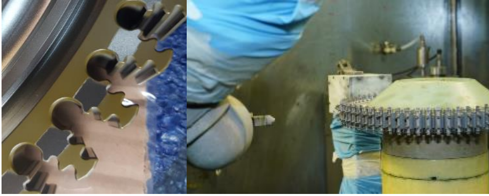
Şekil 39. TEI'deki türbinlerin disklerinde korozyon önleyici kaplama teknolojisi ile yüksek sıcaklık altında malzemelerin termal şok direnci arttırılmaktadır
