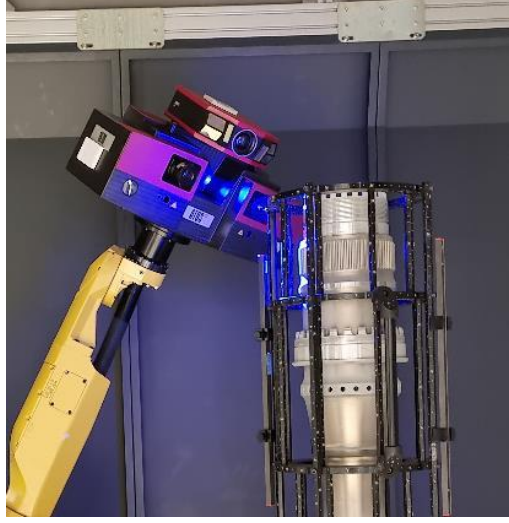
Şekil 38. TEI tarafından geliştirilen özgün “Yüksek Hassasiyetli Optik Ölçüm Kabiliyeti” ile parça üzerindeki tüm ölçüler CMM hassasiyetinde dakikalar içerisinde alınabilmektedir
