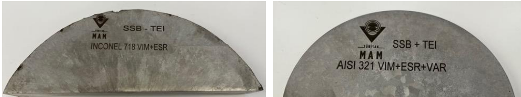
Şekil 26. Türkiye'de havacılık kalitesinde üretilmiş ilk IN718 Nikel Süperalaşımı ve AISI 321 paslanmaz çeliği
