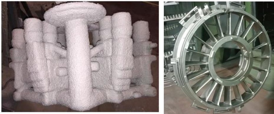
Şekil 24. Türkiye'de havacılık kalitesinde dökülen ilk büyük ölçekli Titanyum motor parçası
