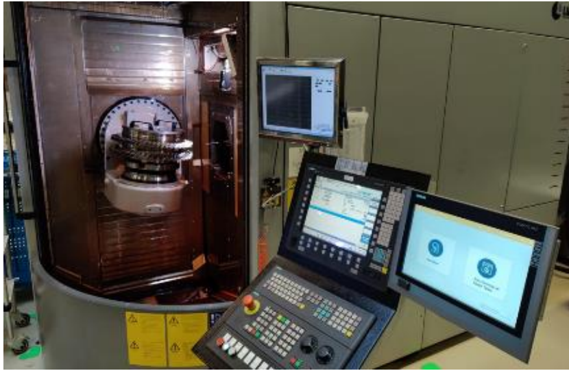
Şekil 41. İleri imalat teknolojileri binasındaki CNC makinelerde nesnelerin interneti (IoT) uygulamaları
