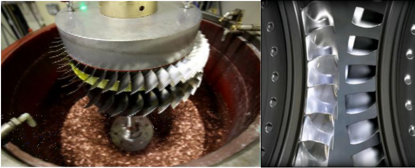
Şekil 40. Ultrapolish Prosesi ile Blisk kanatlarının pürüzlülük değerlerini düşürülerek motorun kompresör performansı arttırılmaktadır
