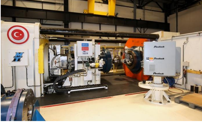
Şekil 32. TEİ elektrot ve kaynak dolgusu olmadan atalet kaynağı yapma teknolojisine sahip dünyadaki sayılı şirketlerden biridir
