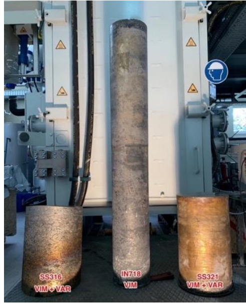
Şekil 27. Türkiye’de havacılık kalitesinde TÜBİTAK MAM laboratuvarlarında üretilmiş ilk IN718 Nikel süper alaşımı, AISI 316L ve AISI 321 paslanmaz çeliği fırından çıktıkları kütükler halinde
